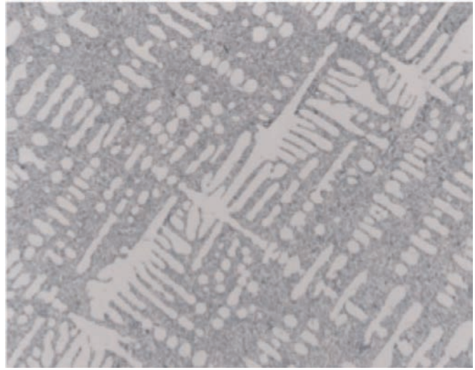
As-cast hypoeutectic Al - 11.8% Si, mostrando \alpha dendritas y \alpha -Si eutectica. Atacada con solución Acuosa 0.5% HF. Magnificación a 50 X con grano refinado y modificado.
