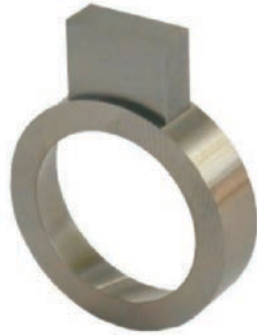
Fig1. Block, testigo nitrurado de acero H13, Anillo Contratestigo de acero D2
