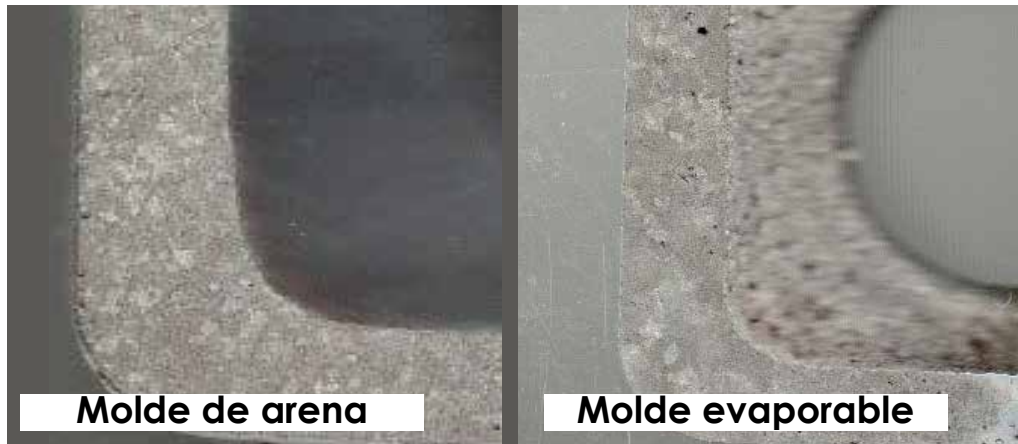
Figura 5. Comparación del tamaño de grano entre la pieza colada en molde de arena y colada por modelo evaporable. Escala 1 mm cada división.
