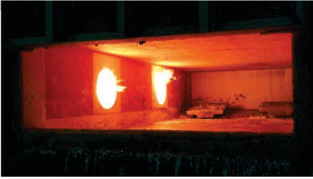
Figure 1: Central de fusión con un horno de bóveda alta y área de precalentamiento
