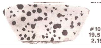
Figura 3. (a) Panque obtenido en la prueba RPT y (b) Muestra seccionada en la que se observa la porosidad presente, los valores indican el % de porosidad y la densidad.
