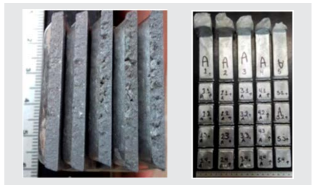
Figura 2. Barras obtenidas por el molde K y detalle de una barra fracturada.
