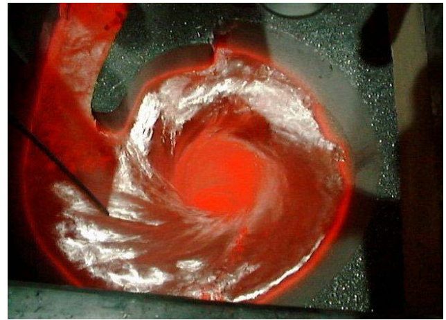
Proceso fusión ALUSWIRLER, por inmersión con vórtice en recirculación metal líquido.
