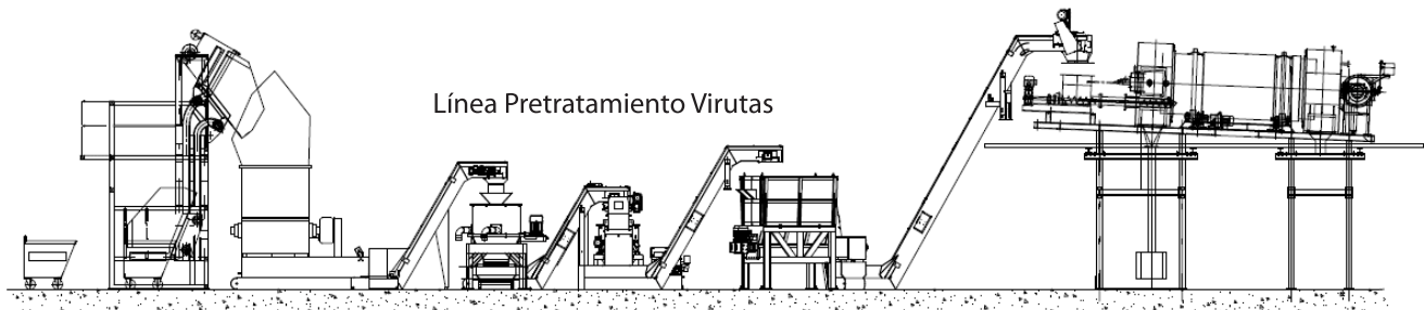
Cestón / Cargador / Triturador / Centrifuga / Separador magnético / Tolva almacén / Secador Virutas
